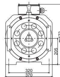
Dimensões para montagem (mm)
