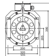
Dimensões para montagem (mm)
